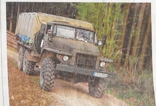
Fahrzeuge wie der Ural 375D kommen unter anderem als Langholztransporter zum Einsatz.
